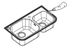
A. 台上安装 将夹子按图示挂在小槽背面的安装孔上。 • 将夹子的齿耙调整为平行于水槽边的方向。
