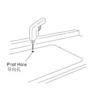
the opening in the countertop 沿着画出的轮廓线切出 水槽安装孔。
