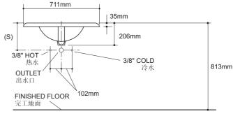
(S) 254mm: 此尺寸根据305mm冒口计算,须按实际情况调整。
