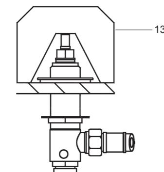
**注意：**将阀体定位，使得面向龙头时贴有蓝色标记的阀体位于右面。为了安装方便，可以适当旋松T型接头，但不要超过180度。安装必须保证软管水流顺畅。
