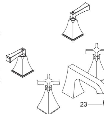
将起泡器(23)取下。打开水龙头的冷热水，让水流一分钟以清除杂质。冲洗起泡器，关闭阀，重新装回起泡器。
