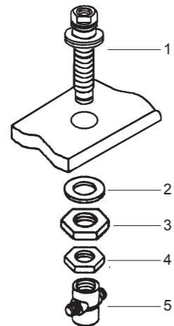
安装垫片(2)和螺母(3、4)。上下同时用力拧紧螺母(3)，然后拧紧螺母(4)。
