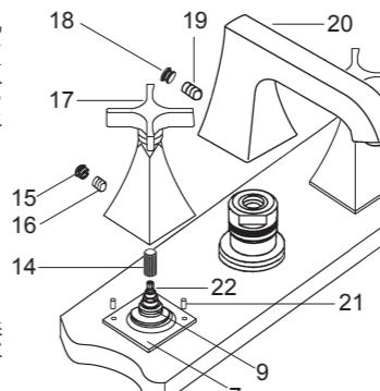
将出水口(10)插入牙管，直至与台面接触。用六角扳手锁紧出水口背部螺钉(19)，然后将塞子(18)塞入螺钉孔。
