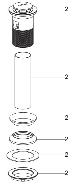
把排水本体从脸盆上部孔插入。再依次将橡胶垫圈(小面朝上)、塑料垫片和锁紧螺母从排水本体底部装入。将锁紧螺母锁紧。
