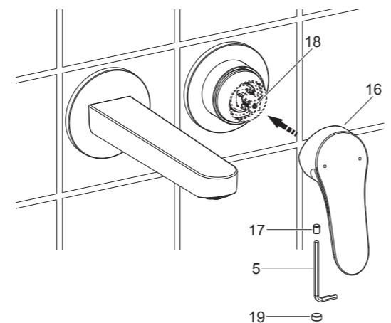
阀芯处于关闭位置时，出水口和把手安装完毕状态如图所示。
