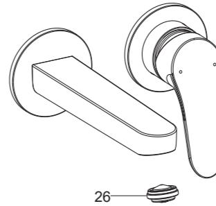
用硬币拆下起泡器(26)。打开水龙头冷热水，让水流约一分钟以清除杂质，检查渗漏。冲洗起泡器，关闭水龙头，重新装回起泡器。
