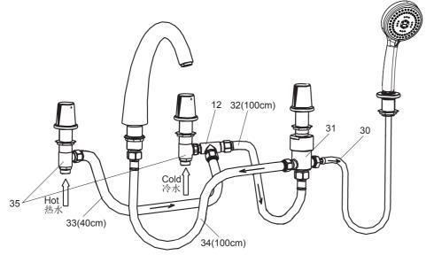
在软管(30)的连接螺母内放入垫片,并将其锁紧到切换器(31)的花洒接口(带单向阀的的一端)上。在软管(32)的两端连接螺母内分别放入垫片,连接T型接头(12)和切换器的进水接口。然后用长40cm的软管(33)连接两阀体(35),最后用软管(34)连接浴缸出水口和切换器的另一端接口。锁紧所有的连接螺母。
