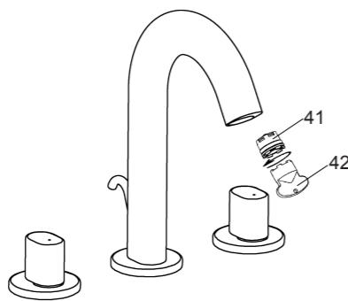
用附带工具(42)将起泡器(41)拆下，打开水龙头的冷热水，让水流一分钟以清除杂质，检查渗漏。冲洗起泡器，关闭水龙头，重新装回起泡器。
