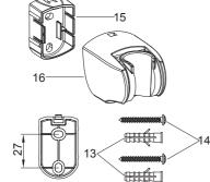
旋紧螺钉(14), 使底座(15, 平面朝上) 固定紧贴墙壁。将托架(16)扣在底座 上, 使凸台嵌入豁口。
