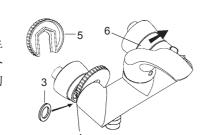
将垫片(3)放入螺母(4)中,用辅助扳手 (5)拧紧,然后用带状扳手锁紧。两个 螺母都拧紧后,将装饰盖中可伸缩的 部分(6)按图示方向旋转, 然后释放, 其将自动弹出。
